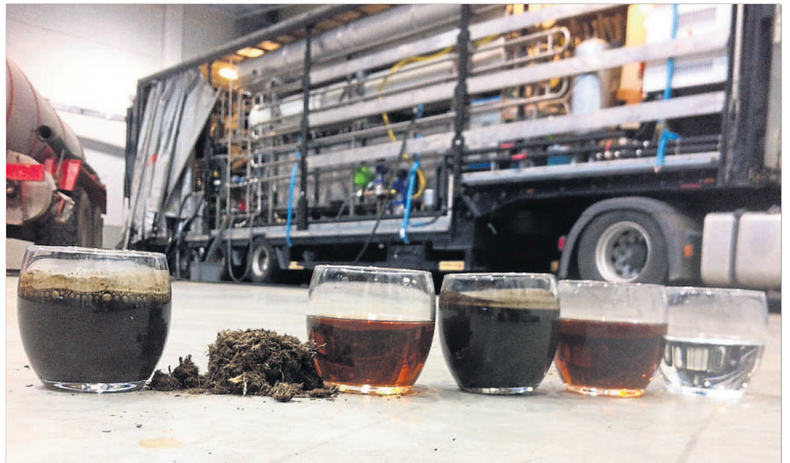
Von der Gülle bis zum Trinkwasser: Die mobile Filteranlage der Firma Ama Mundu passt auf einen Lastwagen und teilt den schwierigen Stoff in nutzbare Teile auf, darunter auch Dünger. (FOTO: AMA MUNDU)
